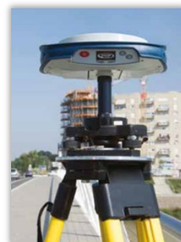
Figura 4: Drone Phantom 4 Pro (Izquierda) - Receptor GNSS SP80 (Derecha).
